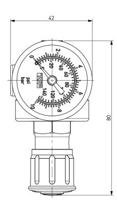
ATTACCO BOMBOLA SECONDO NORMA UNI 11144 - DIN 477 MAX PRESSIONE DI INGRESSO= 120 BAR MAX REGOLAZIONE RIDUTTORE= 5,5 BAR ±0,5 INIZIO SFIATO VALVOLA DI SICUREZZA= 7 BAR +0,5 MAX SOVRAPRESSIONE= +8%
